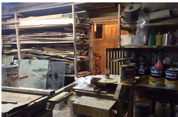
Deficiencia lumínica, desorganización de trabajo, sustancias químicas mal situadas
