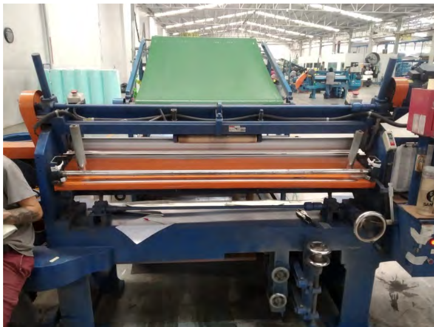
Figura 5. Rodillo instalado en la máquina de división de rollos de EVA.
