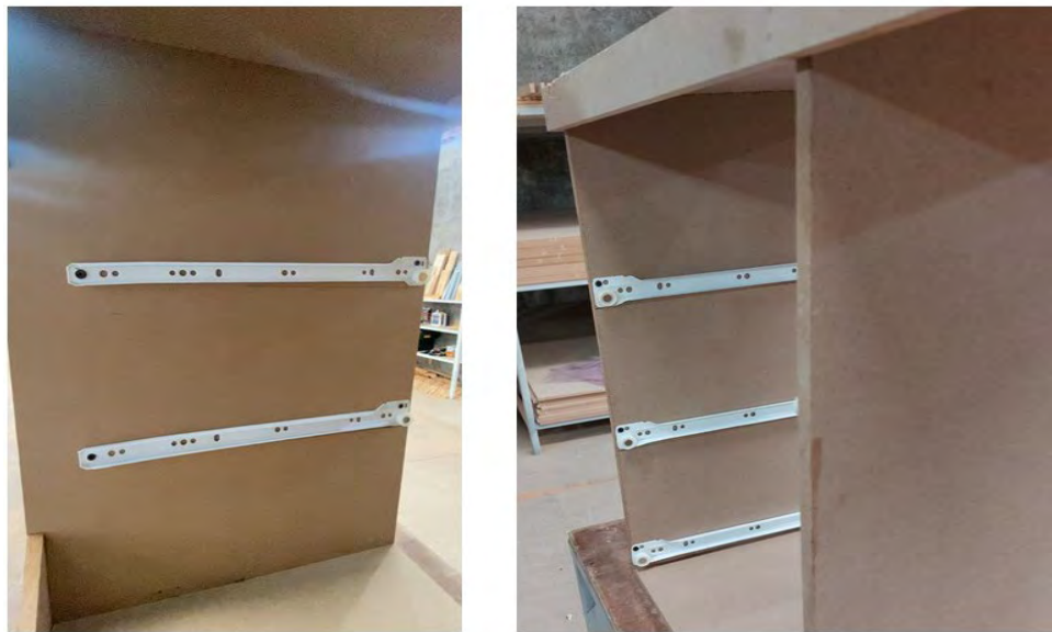
Figura 18. Rieles colocados ya con el Poka Yoke.
