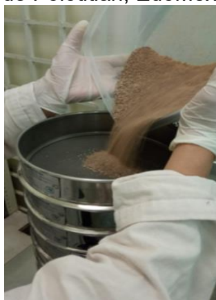
Figura 3.26 Prueba granulométrica de suelo sano del sitio de disposición final de Polotitlán, EdoMéx.
