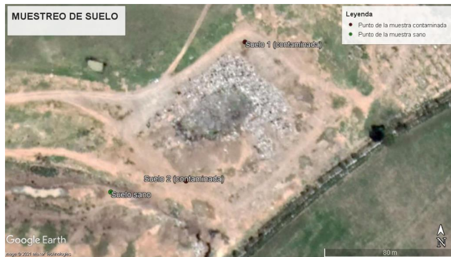
Figura 3.24 Puntos de muestreo de suelo en el sitio de disposición final de Polotitlán, EdoMéx
