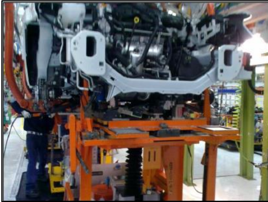
Figura 29. Mejoras en las paletas para un cámber más positivo
