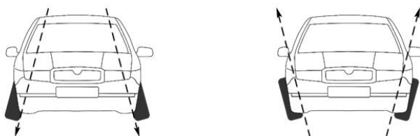
Figura 2.9. Desalineación positiva y negativa
