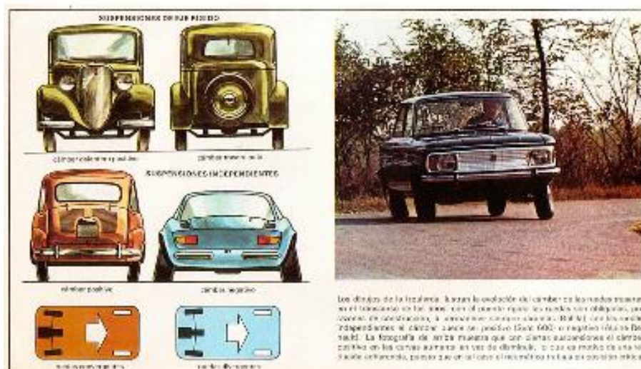
Las diferencias entre cámbel nulo, positivo y negativo. También se puede apreciar en la fotografía el agarre en una curva con cámbel positivo en el eje trasero.
