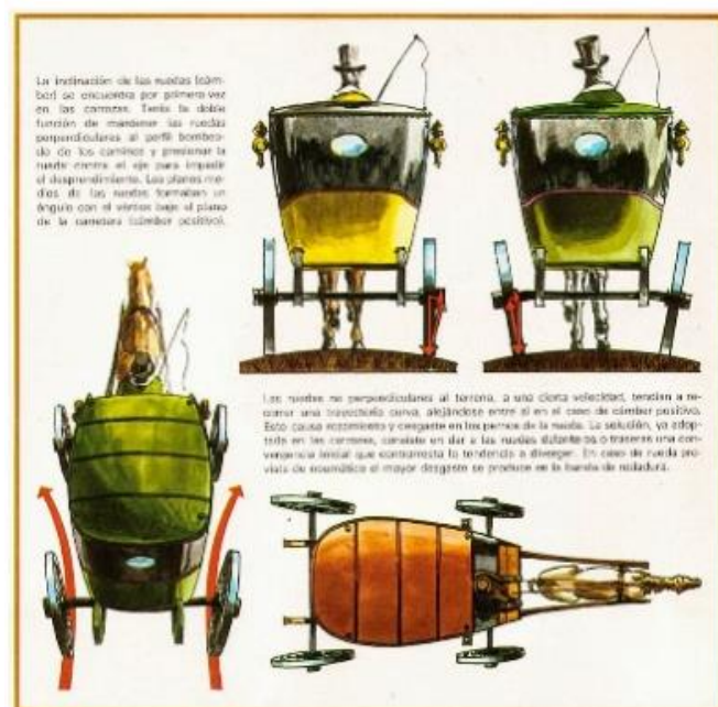
Vemos cómo es la diferencia entre ruedas verticales al suelo y con inclinación positiva. También podemos apreciar la convergencia de las ruedas delanteras y traseras en un carruaje tirado por caballos.
