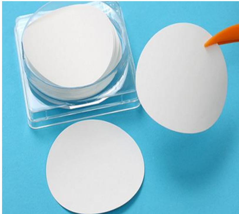
Figura 13. Filtro de Nucleopore de 47 mm, para monitoreo de aire. (Microimport, 2020)
