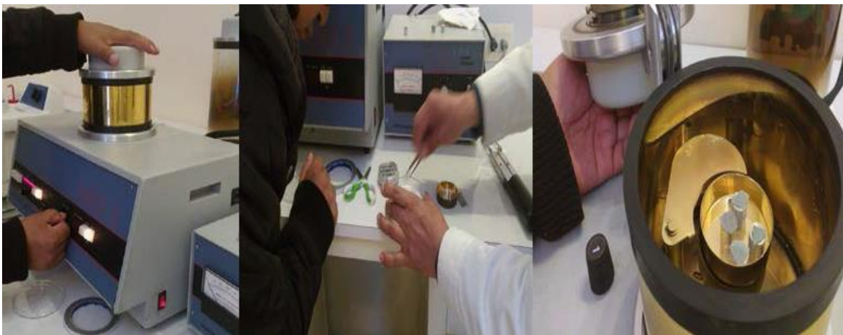
Figura 18. Baño de oro realizado a las muestras en el equipo Denton Vacuum, Desk II
