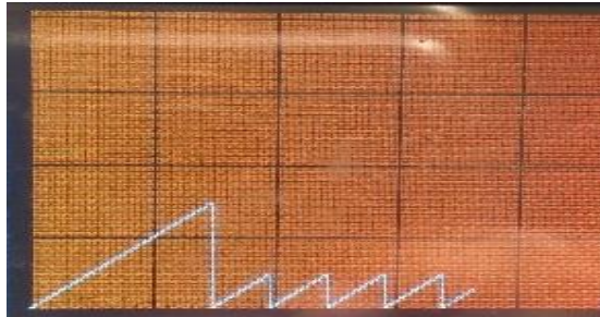
Figura 4. 31 Curva característica de diente de sierra característica de la interfaz de control, el pico más grande represento el proceso de ignición para poder generar el voltaje de rompimiento.
