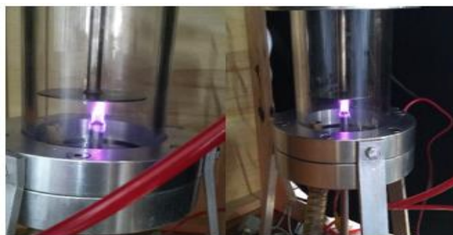
Figura 5. 7 Cabina del reactor magnetrón sputtering, donde se pudo observar una atenuación en el plasma propio del proceso debido a su automatización.
