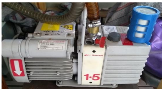
Figura 4. 25 Bomba mecánica para la generación de vacío en el interior de la cabina del reactor de plasma.
