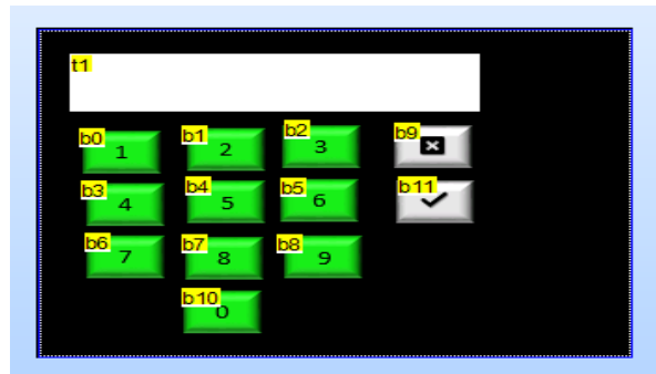
Figura 4. 19 Pantalla de contraseña del sistema, en la imagen se muestran los botones y panel que conformaron esta pantalla durante su desarrollo.
