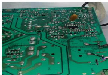
Figura 5. 1 Tarjeta de potencia modificada, en la imagen se muestra uno de ellos capacitores agregados a la placa.
