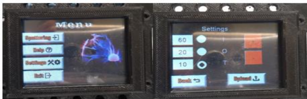
Figura 5. 4 Resultados obtenidos de la validación hecha a la interfaz de control, a la derecha se puede observar la pantalla de configuración de parámetros de funcionamiento, 60 es el porcentaje del ciclo de trabajo del proceso de ignición, 20 es el porcentaje en la disminución que se tiene y 10 son los segundos que dura el proceso completo.
