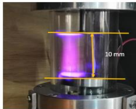
Figura 4. 28 Modificación en la distancia entre electrodos a 10 mm para una mayor concentración de energía.
