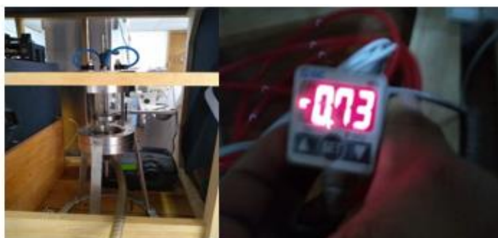
Figura 5. 5 Cabina del reactor magnetrón sputtering (a la izquierda) y presostato (a la derecha), se observó una presión de 0.73Mpa suficientes para el proceso de ignición del sistema.
