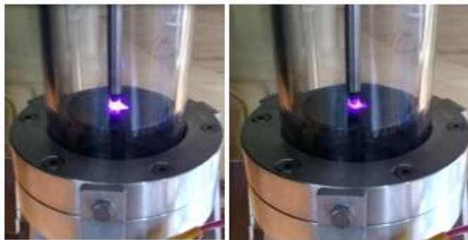
Figura 4. 32 Modulación del flujo de plasma generado por el reactor de plasma controlado por la interfaz.
