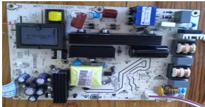
Figura 4. 5 Tarjeta electrónica de potencia de CCFL (Lámparas fluorescentes de cátodo frio), en la imagen puede observarse los distintos componentes que se encuentran en ella tales como transformador de pulsos, transformador elevador, capacitores.
