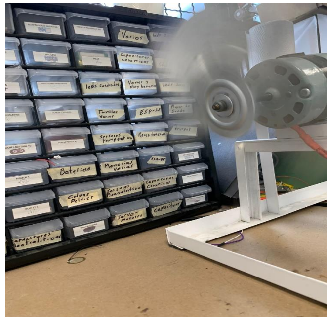
Ilustración 55 Ventilador usado para obtener la medición de la velocidad del viento.
