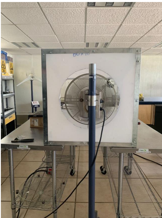
Ilustración 61 Parte trasera del túnel de viento
