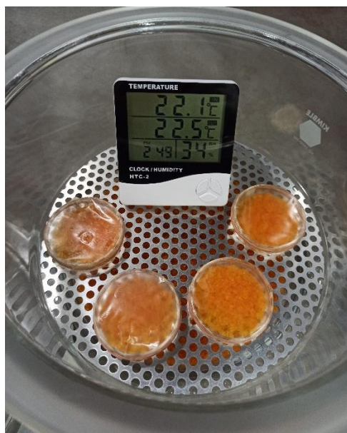
Figura 4. Prueba de permeabilidad al vapor de agua de las películas.
