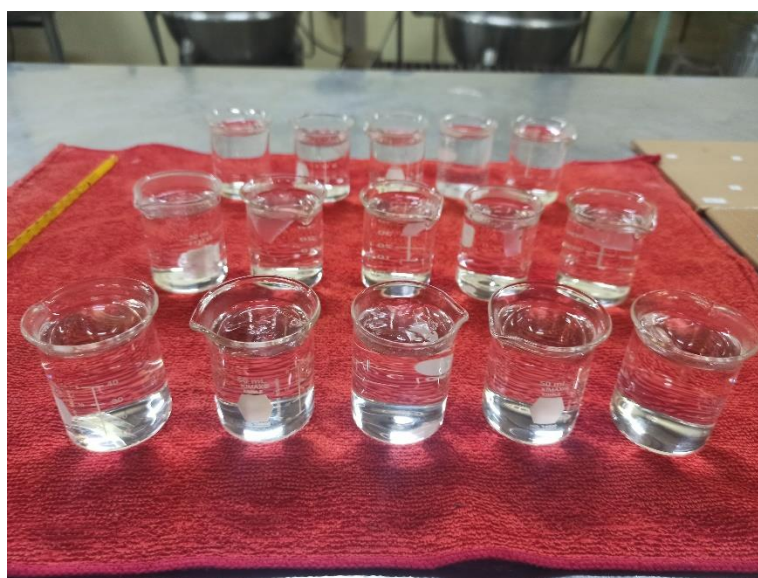
Figura 8. Prueba de resistencia térmica de las películas en agua.
