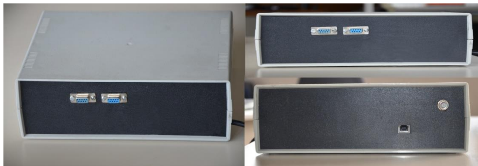
Figura 68. Caja para los circuitos electrónicos del Sistema portátil de Posicionamiento de Detectores de Radiación, vista general (izquierda), vista frontal (derecha arriba), vista posterior (derecha abajo)
