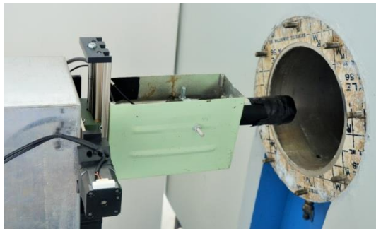
Figura 76. Instalación del equipo para medir el perfil del haz de neutrones en uno de los puertos del reactor TRIGA MARK III del ININ.
