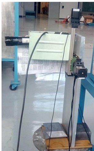
Figura 62. Soporte vertical con mesa de coordenadas y detector.
