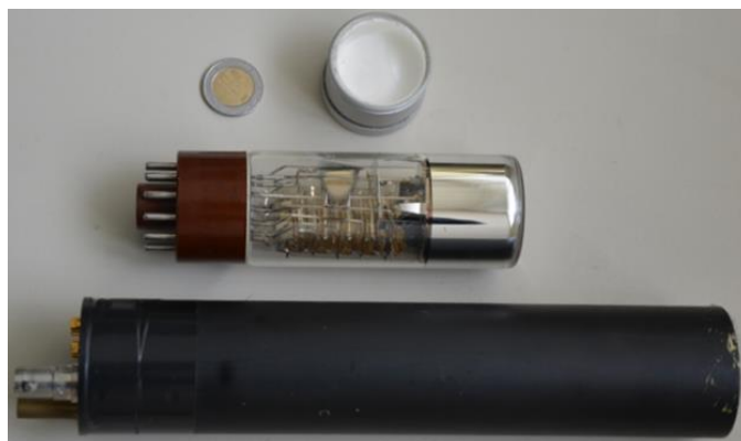
Figura 16. Detectores de centelleo y tubos fotomultiplicadores
