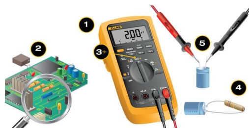
Figura 3.1.2.6 Medición de un capacitor.
