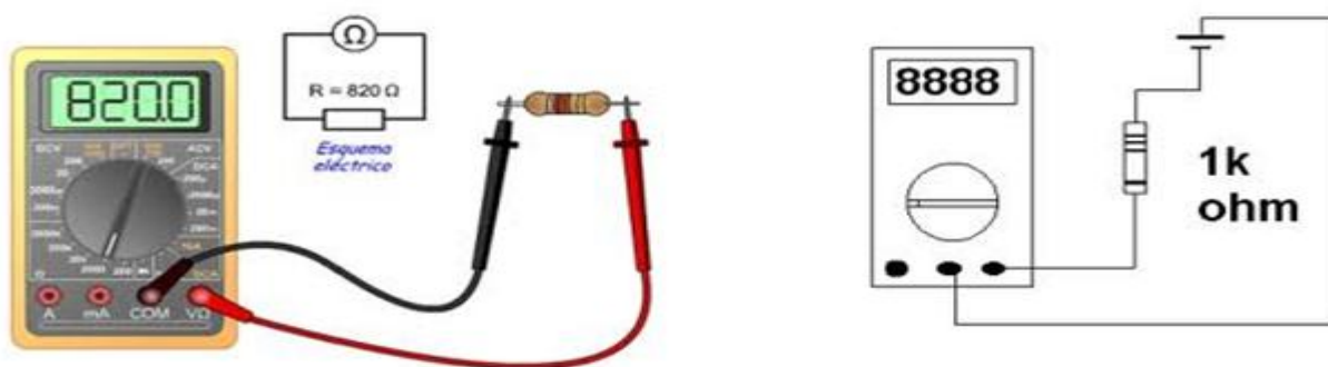
Figura 3.1.1.5 Medición de una resistencia.
