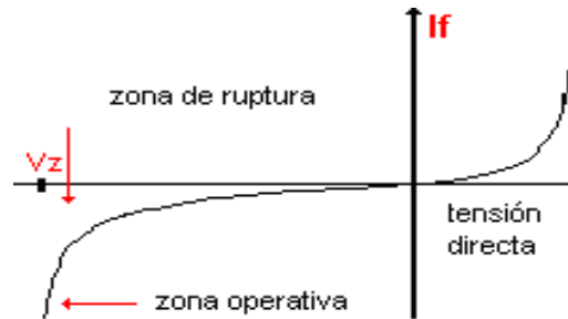
Figura 1.39 Curva característica del diodo Zener.
