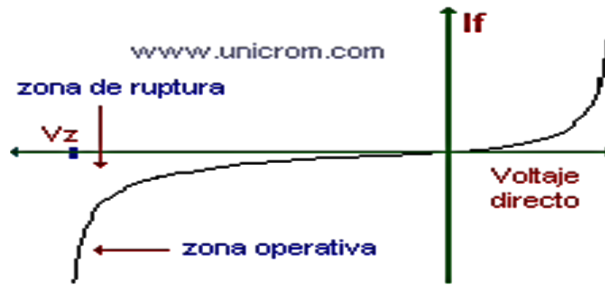
Figura 1.35 Curva característica del diodo Zener.
