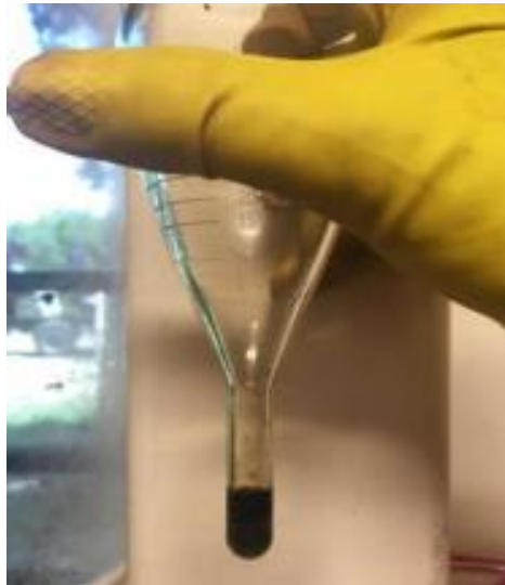
Imagen 3. 17 Determinación del porcentaje de sólidos.
