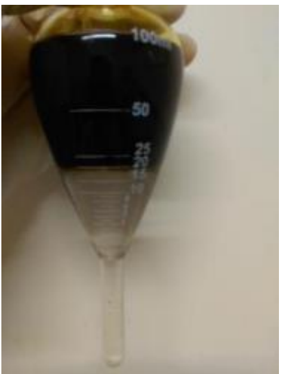
Imagen 3. 14 Determinación de sólidos, agua y aceite.
