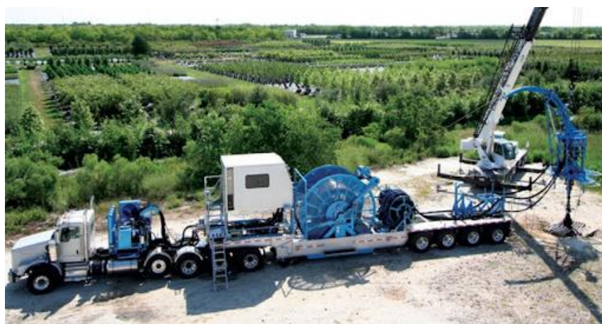
Imagen 2. 21 Unidad de Tubería flexible. (TPMexicana, 2020)
