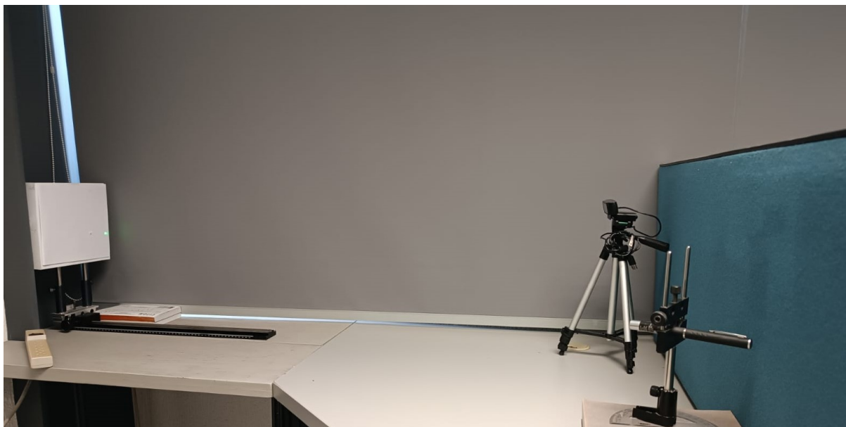
Figura 4: Diseño propuesto empleando de una distancia mayor a un metro del plano de referencia al SVL.
