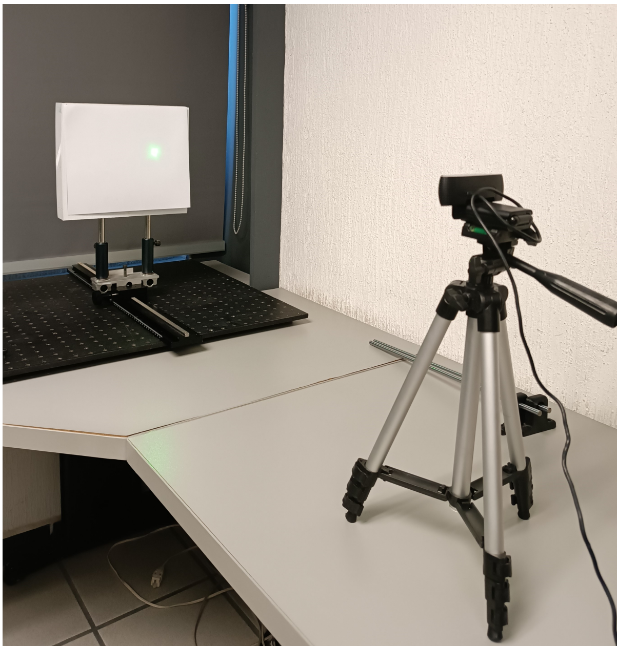
Figura 2: Panel de referencia (fondo) y trípode (derecha) del sistema de calibración.
