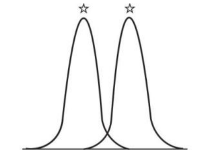
Figura 11. Criterio de Rayleigh. Fuente: "Construcción de un interferómetro de dos elementos" de Carolina Berenice Rodríguez Garza.
