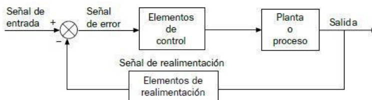
Figura 36. Diagrama de bloques de sistema en lazo cerrado. Fuente: Research Gate.
