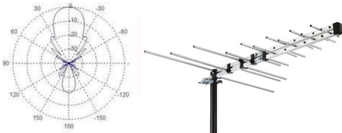
Figura 16. Antena Yagi-Uda, a la izquierda se muestra el diagrama de irradiación, el lóbulo crece sólo a un lado por acción del reflector y los directores provocan un alargamiento. Fuente: Todoantenas.
