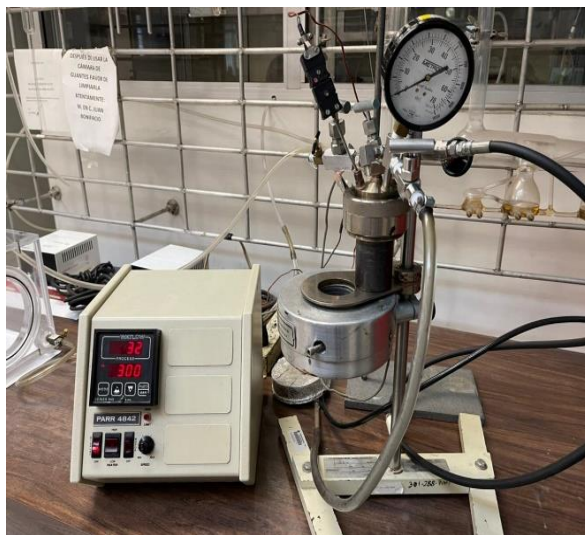
Figura 2.3. Reactor Parr ® con controlador de temperatura.
