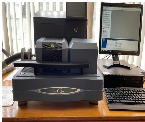
Figura 2.4. Calorímetro simultáneo SDT Q600, TA Instruments.
