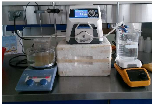
Figura 2.3 Goteo de solución Q-PVA con aguja 21G en baño maría.
