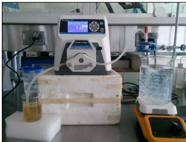
Figura 2.4 Goteo de solución Q-PVA con aguja 17G a temperatura ambiente.
