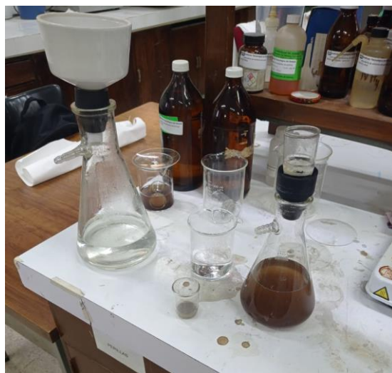
Figura 3. Filtrado y lavado de la muestra.
