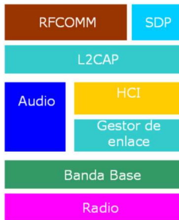
Fig. 6.14 Pila de protocolos del Bluetooth.
