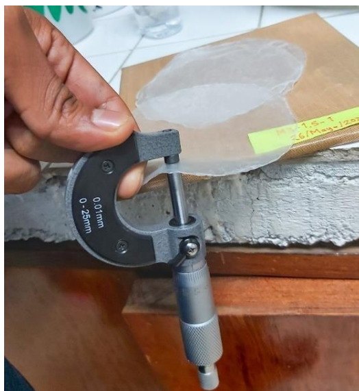
Figura 10. Medición del espesor de la película comestible M3-1.5.
