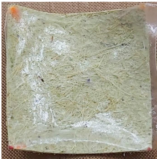
Figura 17. Falta de adherencia de películas a base de mucílago de nopal en láminas de hojas de elote.
