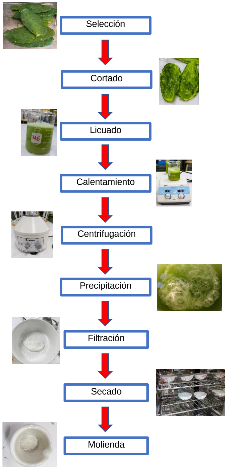
Figura 6. Proceso de extracción del mucílago de nopal.
