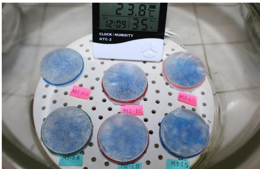
Figura 13. Prueba de permeabilidad de vapor de agua en las películas comestibles.
