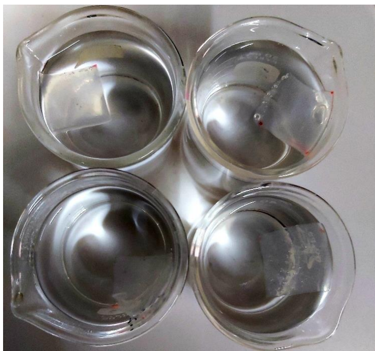
Figura 18. Prueba de resistencia térmica de las películas comestibles.
