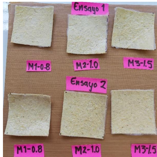
Figura 15. Prueba de adherencia de las películas comestibles.
