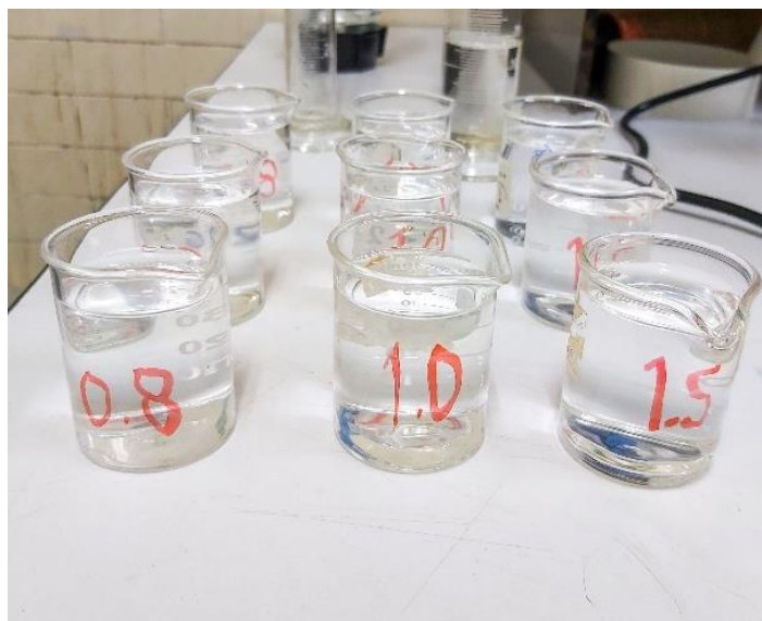
Figura 11. Prueba de solubilidad de las películas comestibles en agua
