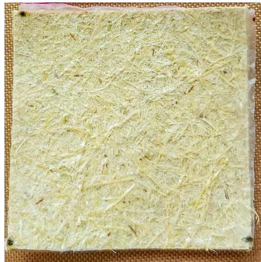
Figura 16. Adherencia de películas a base de mucílago de nopal en láminas de hojas de elote.
