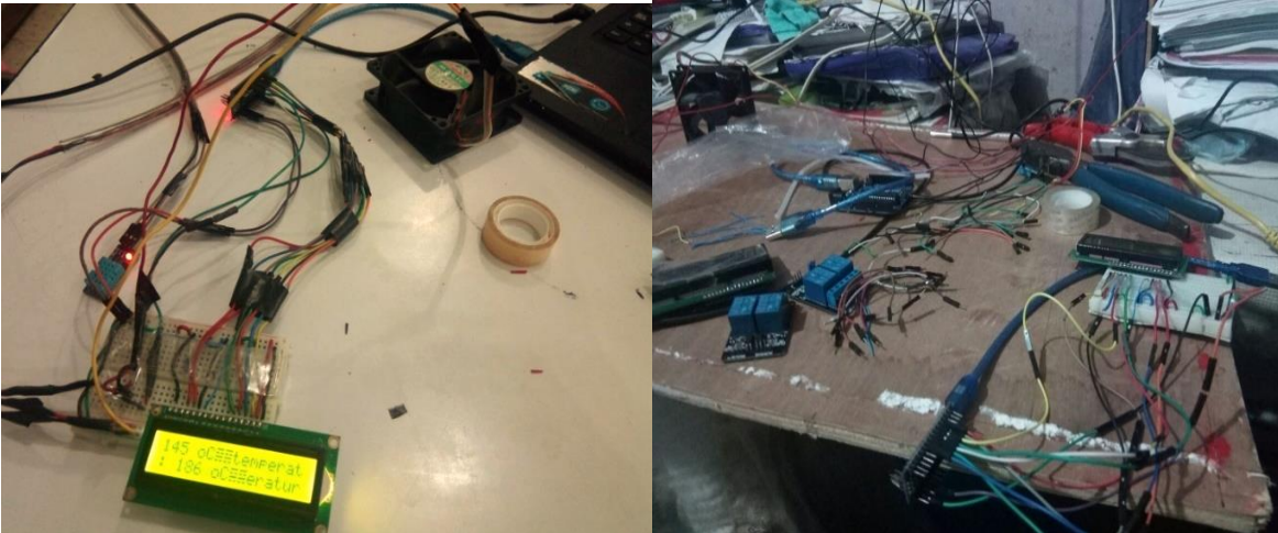
Figura 16. Ensamble y programación de sensores de temperatura.
