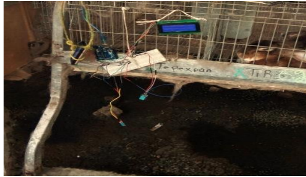
Figura 19. El tercer sensor se colocó debajo de la jaula el cual detectó una temperatura de 28°C.
