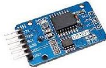
Fig. 2 Modulo Reloj en Tiempo Real DS3231.
