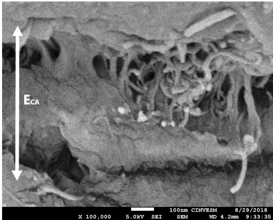
Fig. C2. Imagen SEM de NTC/PSF con aplicación de un campo eléctrico
