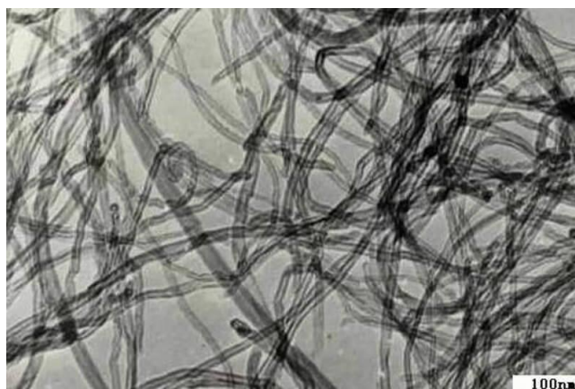
Figura 3.1. Imagen de microscopia electrónica de NTC adquirido de Cheaptubes [99].
