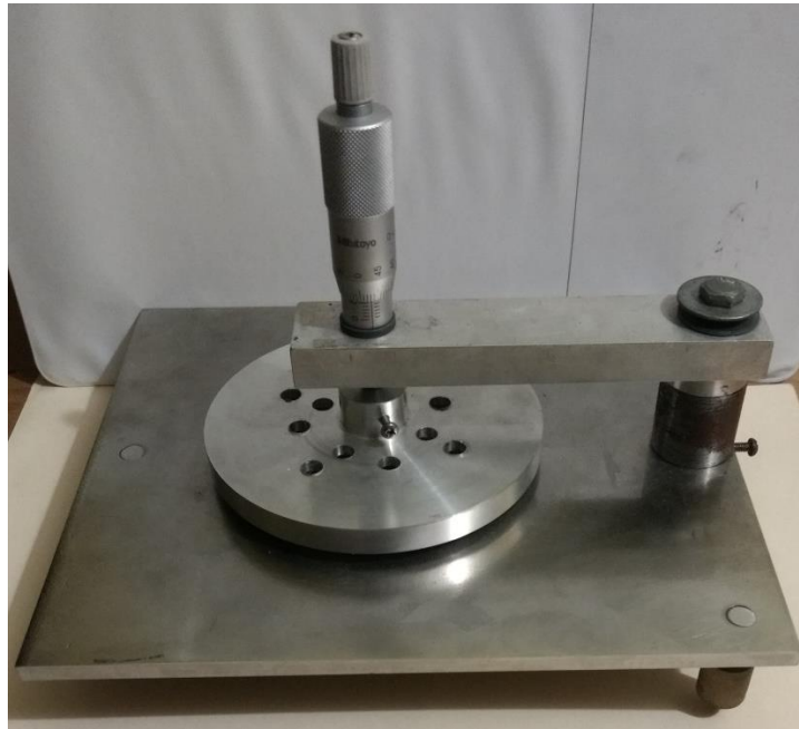
Figura 2.16 Diseño final de la máquina fabricada para orientar los nanotubos de carbono en forma vertical.
