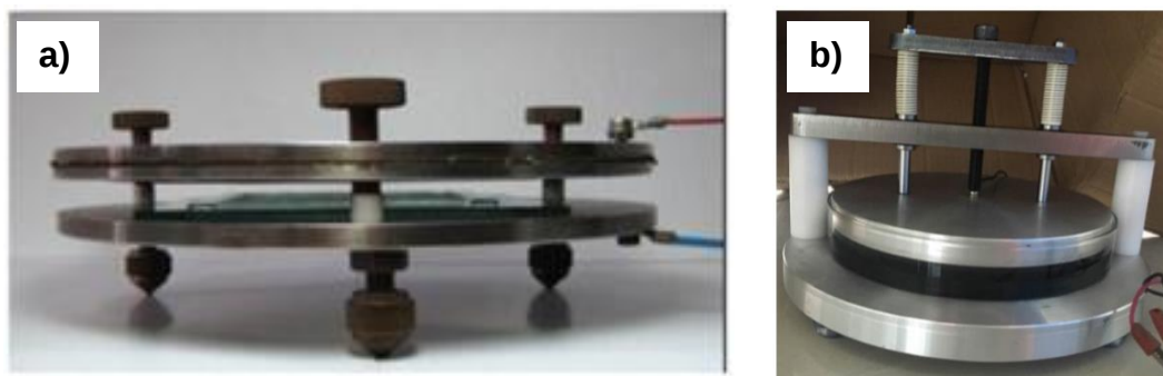
Figura 1.7. Dispositivos para orientar NTCs a través del espesor de los materiales compuestos fabricados. a) dispositivo de placas paralelas para la fabricación de NTC/poliestireno [96], b) dispositivo de placas paralelas para la fabricación de NTC/caucho [97].
