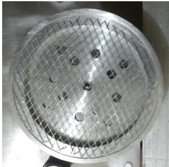
Figura 2.15 Disco con la malla de aluminio ensamblada.
