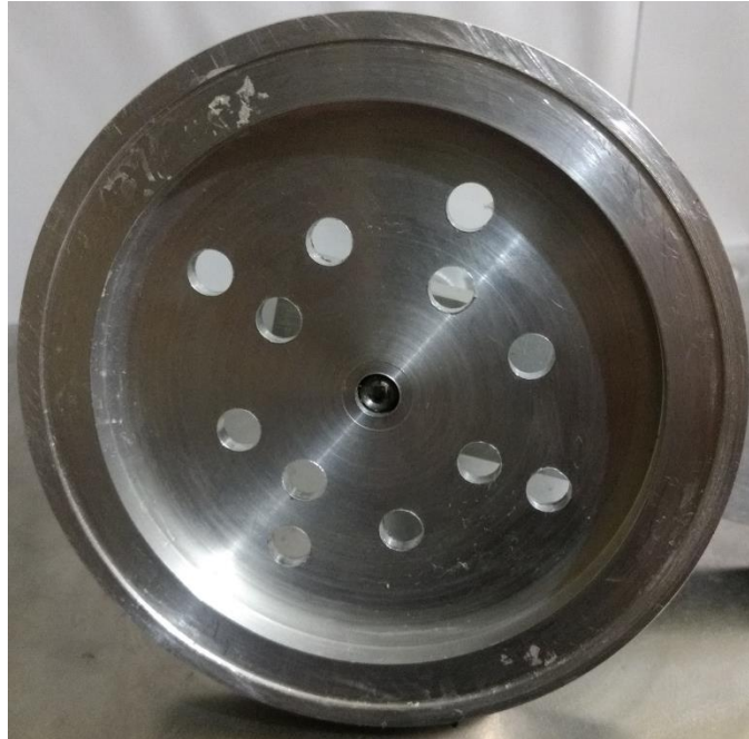
Figura 2.14. Disco terminado con agujeros para la ventilación.
