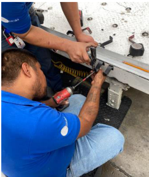
Ilustración 26. Instalación de bases de pistolas neumáticas
