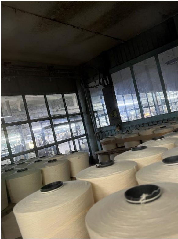
Figura 30 Área de humectación de hilo antes de ingresar al telar
