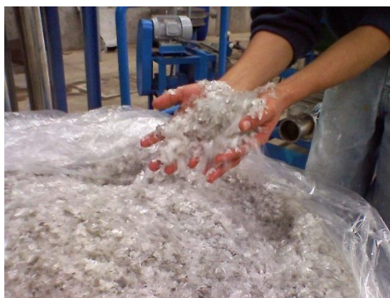
Figura 2—4: Materia prima de PET Molido. Fuente: (La red, reciclados plasticos, 2017).
