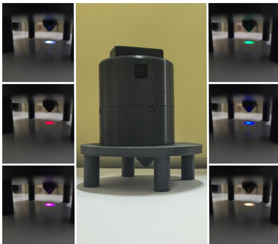
Figura 36. Imágenes del sistema de iluminación (centro) y ejemplos de las diferentes longitudes de onda emitidas. Elaboración propia (2025).
