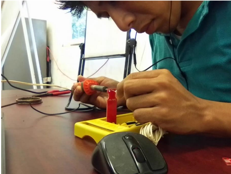
Figura 25: Conexión de cables calibre 22 a los sensores de nivel de agua.
