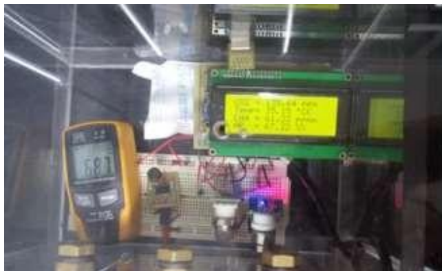
Figura 3.7 Pruebas de medición del patrón y el sistema desarrollado.
