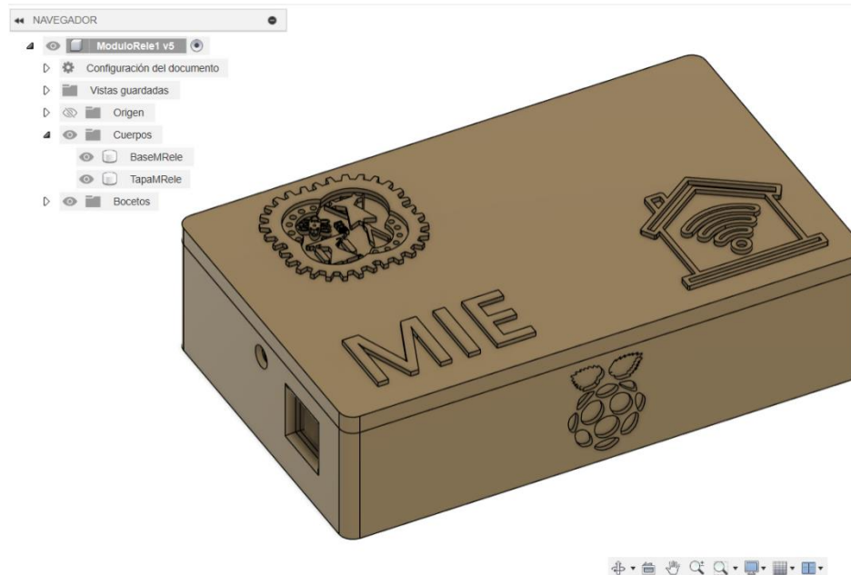
Figura 10: Carcasa módulo 3D para entradas /salidas digitales
