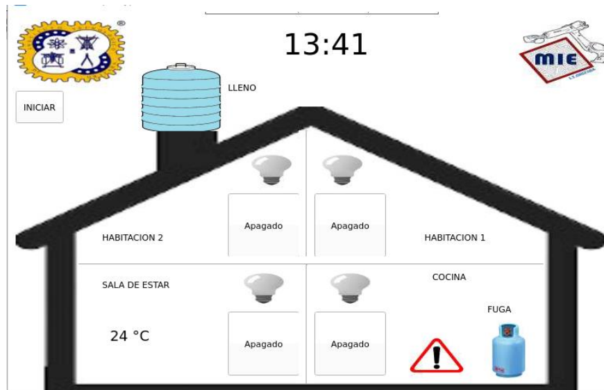
Figura 16: Estado de de alarma por presencia de gas LP
