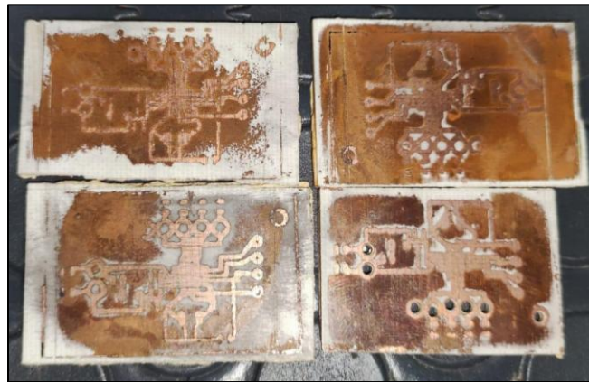
Figura 6. Transferencia del circuito por método de plancha con líneas de 0.4 mm de ancho de pista.
