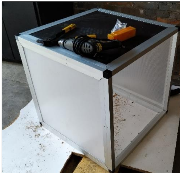
Figura 10. Cabina con tapas de policarbonato.
