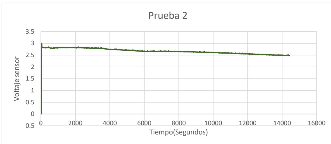
Figura 59. Gráfica de valores de sensor en relación al tiempo de impresión de prueba 2.
