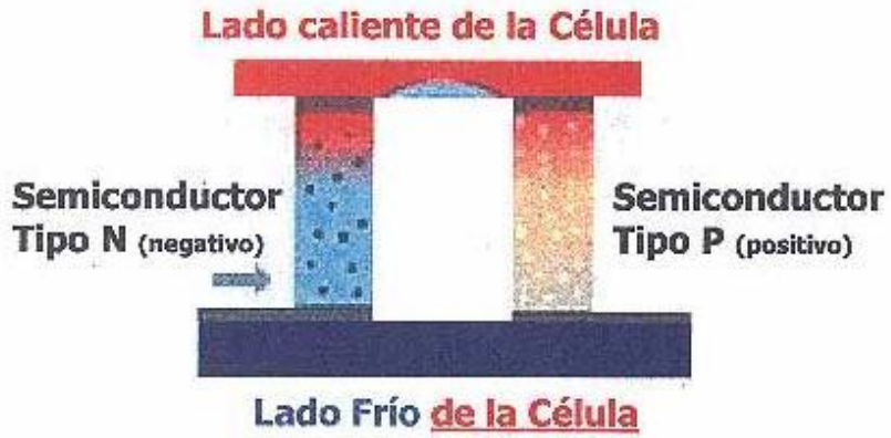
Figura 8 Esquema de funcionamiento de una Célula Peltier.
