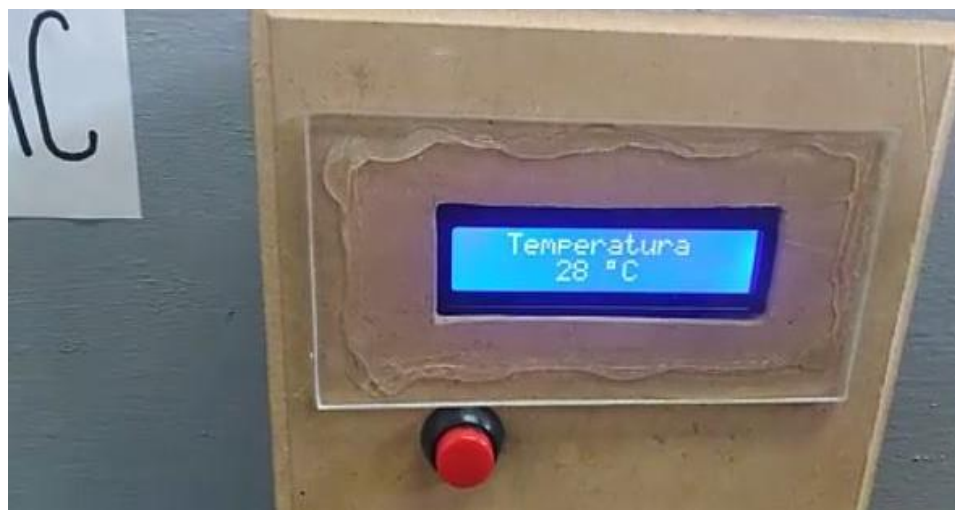
Figura 19 Lectura de la temperatura del agua obtenida por el sistema.
