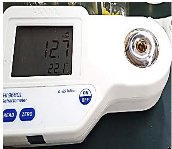
Figura 42. Grados Brix de la muestra 1 con apoyo de un Refractómetro digital.
