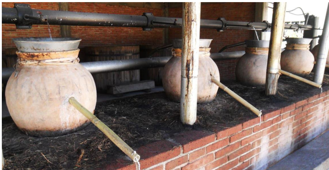
Figura 9. Ollas de barro usadas para la destilación del Mezcal en Villa Sola de Vega.
