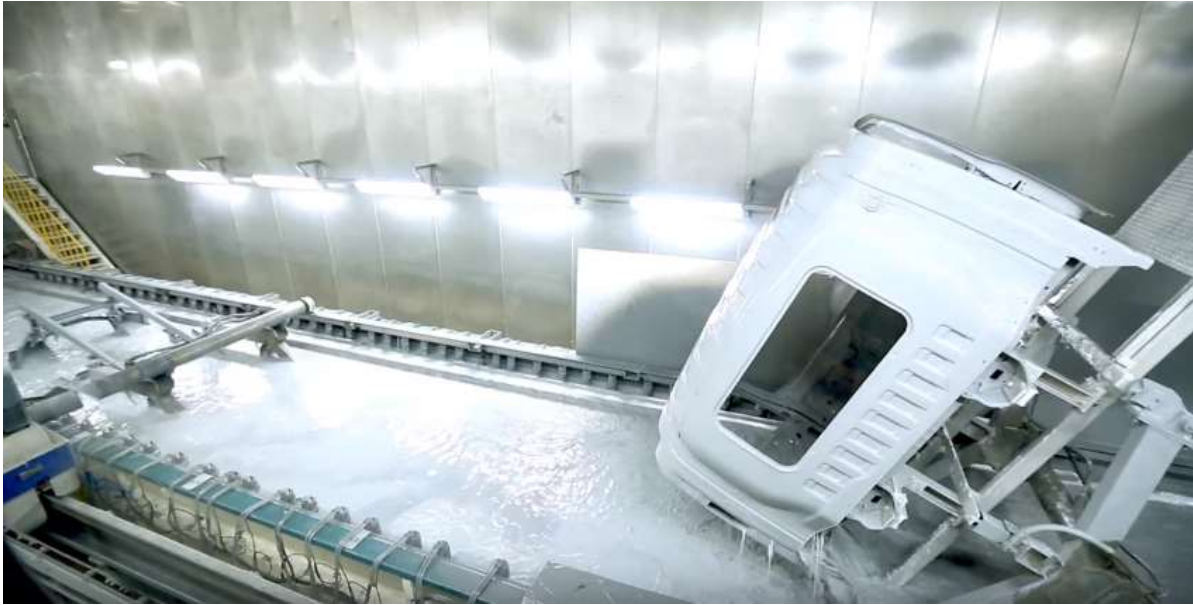
Figura 3.3 Tanque de electrodeposición.
