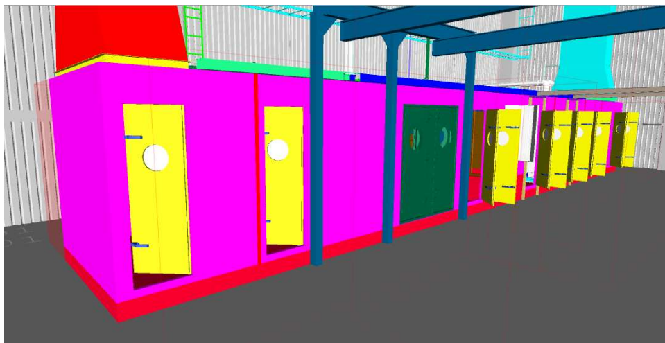
Figura 3.5 Vista exterior de una unidad de preparación de aire.
