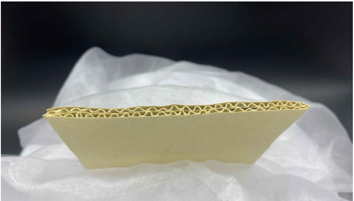
Ilustración 11 Prototipo de cartón corrugado doble.
