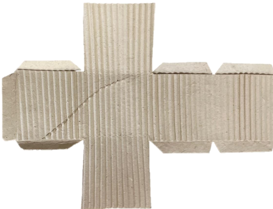
Ilustración 19 Caja de cartón a base de rastrojo de maíz.
