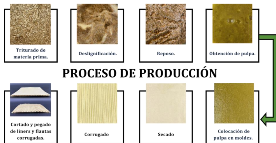
Ilustración 3 Proceso de producción de papel y cartón propuesto. Fuente: Elaboración propia.
