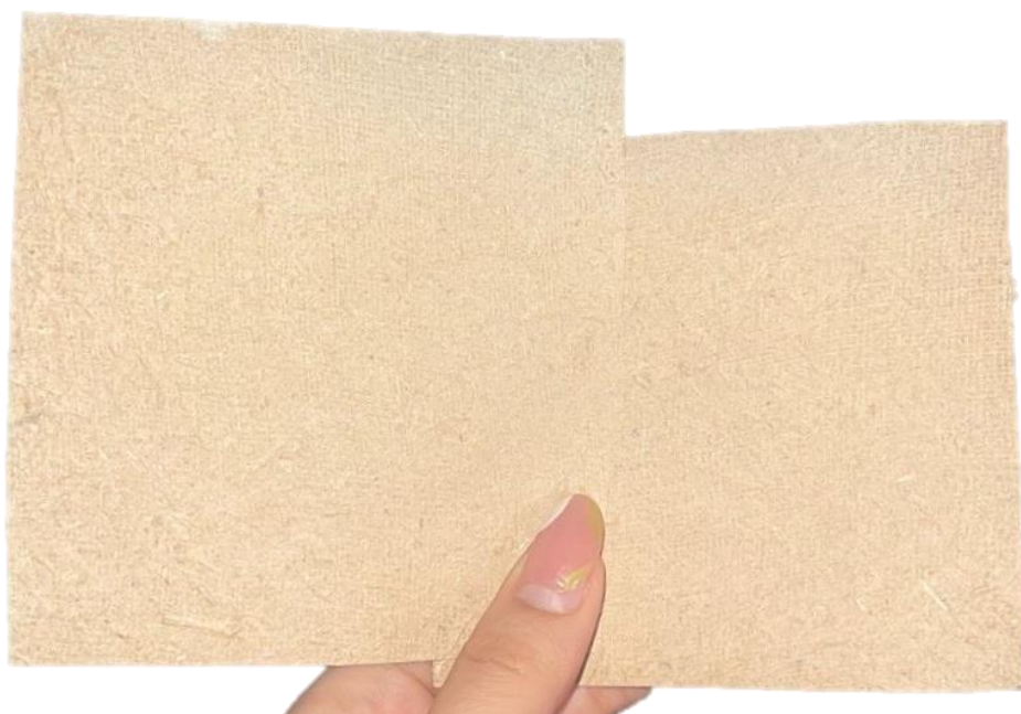
Ilustración 18 Prototipo de cartoncillo a base de rastrojo de frijol.
