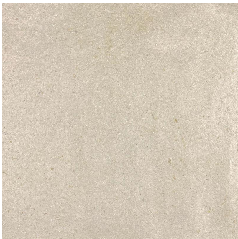
Ilustración 16 Prototipo de papel a base de rastrojo de maíz.
