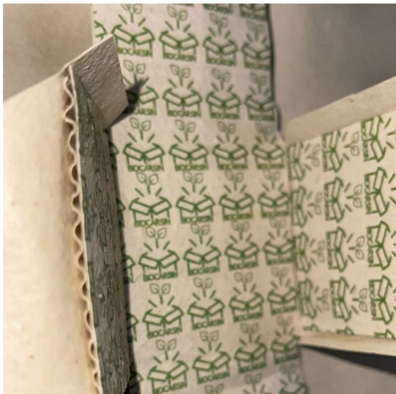
Ilustración 20 Vista interna de las capas del prototipo de caja de cartón.
