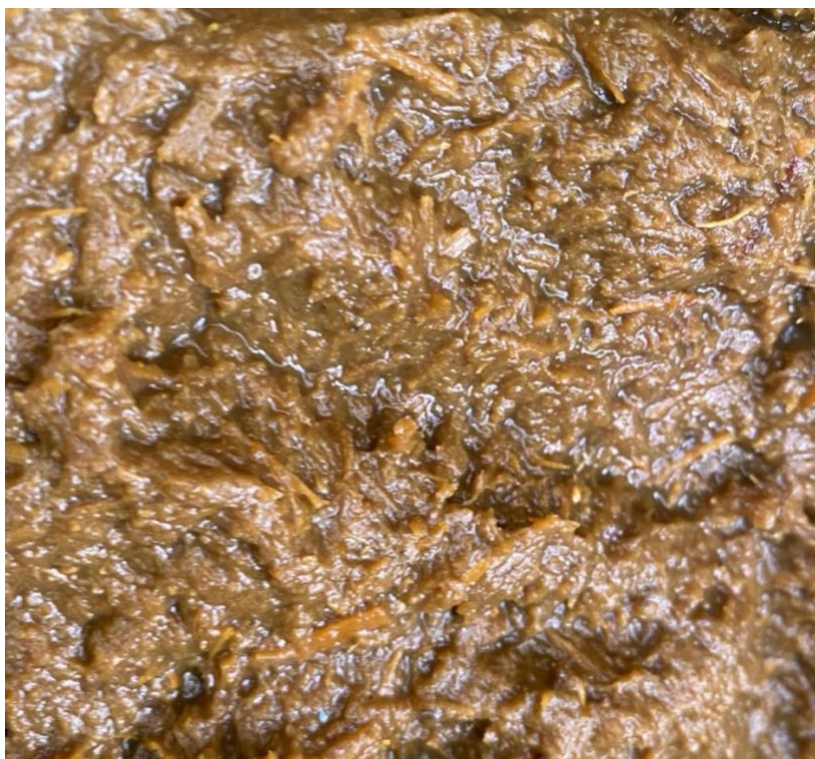
Ilustración 24 Fibras resultantes del proceso de deslignificación.
