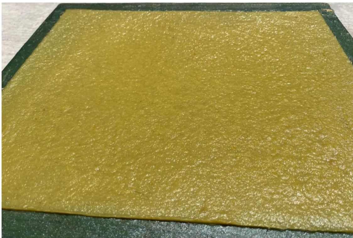
Ilustración 25 Pulpa en molde en proceso de secado al sol.
