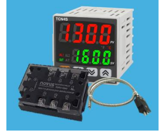
Fig.1.3 Sensor, controlador y actuador
