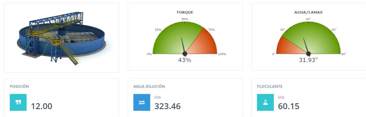
Ilustración 28 Niveles de lamas y reactivo adicionado
