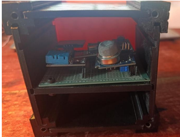
Fig. 51 Incorporación de prototipo de PCB en el interior del satélite
