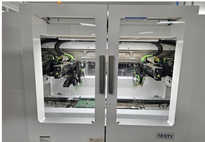
Figura 92. Proceso de producción en Flying Probe
