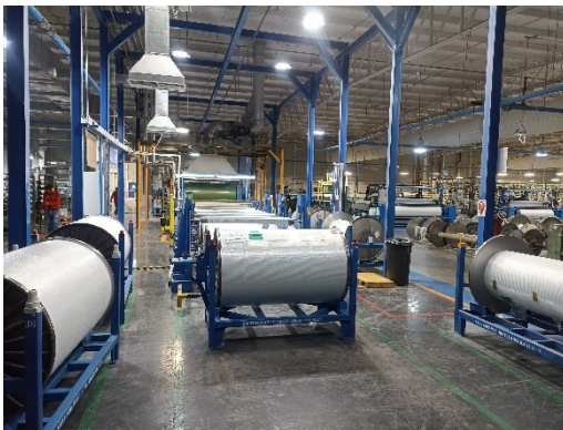
Fig. 2 Colocación de los “Julios” en “raks”.
