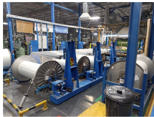
Fig. 3 Posicionado de “beams” y entrada de los hilos al “sizing”.
