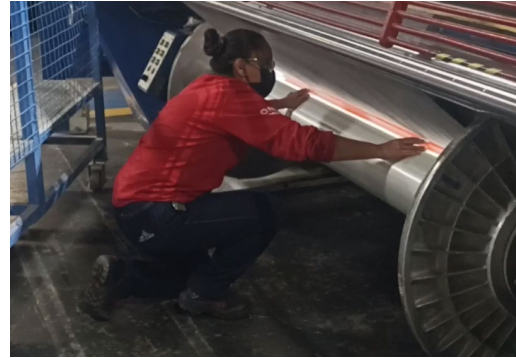
Fig. 2 Limpiado y tensado de hilos en julio a procesar
