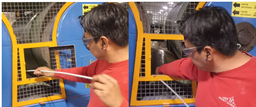
Fig. 3 Des atoramiento y acomodado de hilos rotos.
