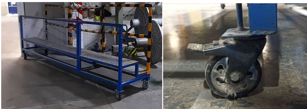
Fig. 12 y 13 Diseño de guarda propuesto para zona de operador.
