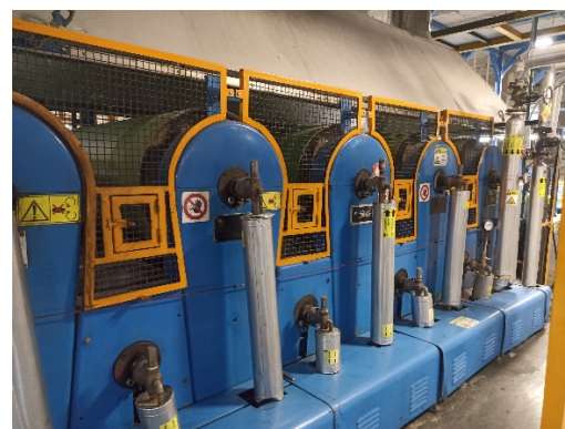
Fig. 5 Secado y fijado del engomado.
