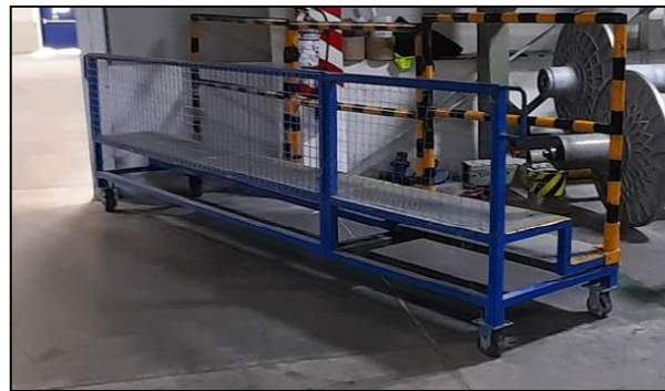
Fig. 4 – 5.- Integración de dispositivo de seguridad y cajón que utiliza el operador.
