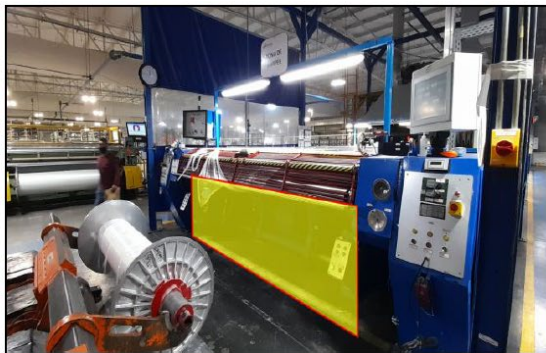
Fig. 4 – 5.- Integración de dispositivo de seguridad y cajón que utiliza el operador.
