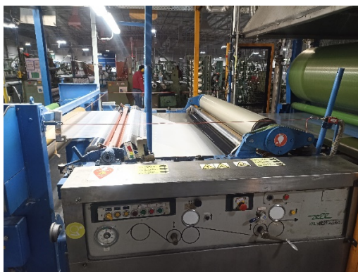
Fig. 4 Recubrimiento de hilos con engomado.
