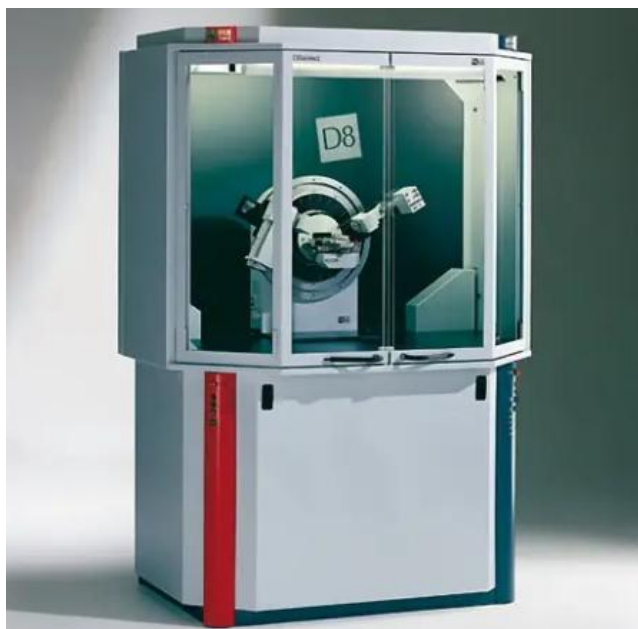
Figura 3.9.1 Difractómetro Bruker D8 Advance utilizado para el análisis de difracción de rayos X (DRX).
