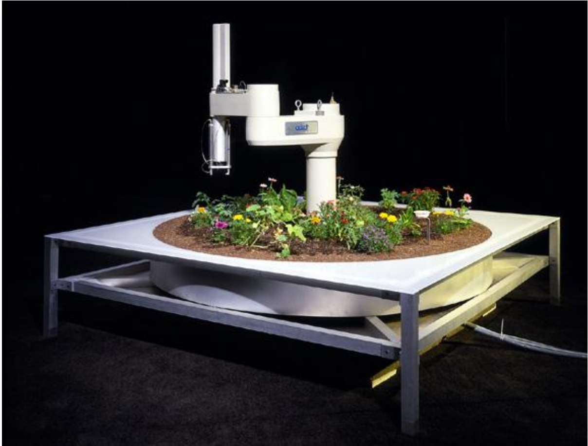
Figura 1.6.1. Telegarden: brazo robótico teleoperado que permitía a usuarios remotos sembrar y regar un micro-huerto (The Telegarden Website, n.d.-b).
