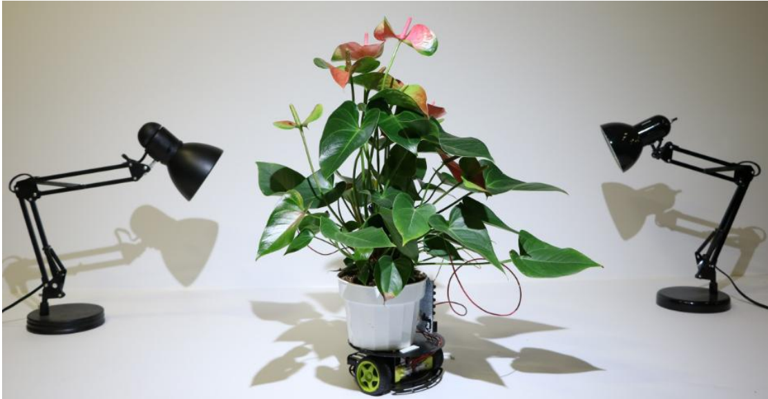
Figura 1.6.3. Elowan: planta-robot híbrido cuyo desplazamiento está gobernado por las señales bioeléctricas del propio vegetal (crédito: M. Patel, 2018) (Overview < Elowan: A Plant-Robot Hybrid — MIT Media Lab, n.d.)
