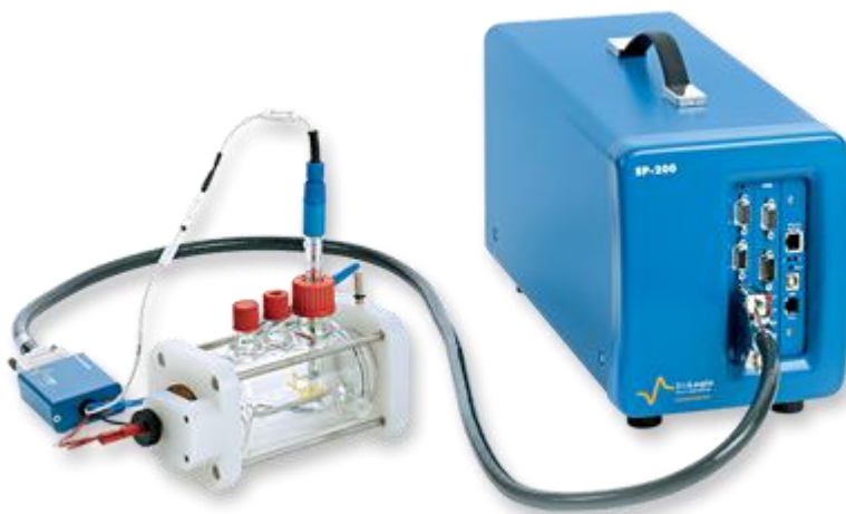
Figura 1.9.1. Potenciostato/galvanostato modelo SP-150 de Bio-Logic conectado a una celda electroquímica, empleado para la medición de corrientes y potenciales en estudios electroquímicos.
