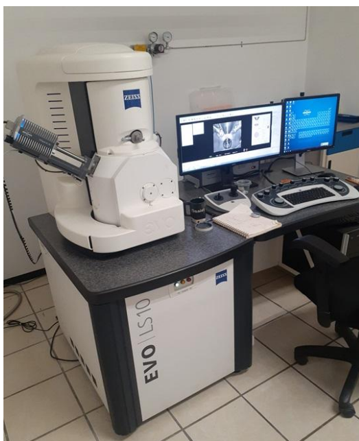
Figura 3.7.1 Microscopio electrónico de barrido ambiental (ESEM) EVO LS10 (Carl Zeiss, Alemania) utilizado para el análisis morfológico de las muestras vegetales.
