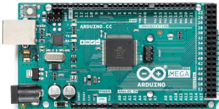
Figura 1.8.3 Microcontrolador ATmega2560 integrado en una placa Arduino Mega.
