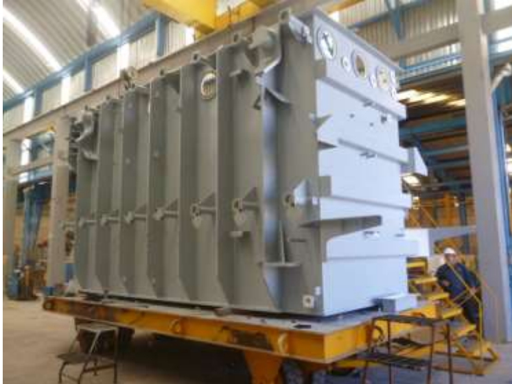
Figura 3.1 Tanque de transformador eléctrico [Fuente: Propia 2023]
