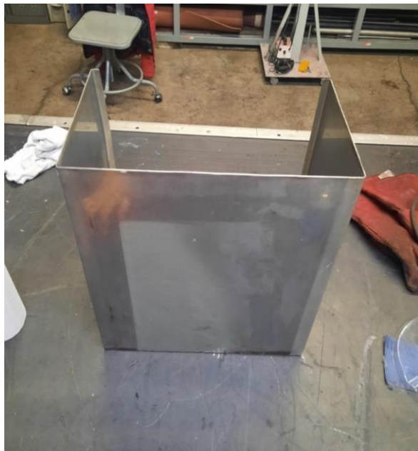
Ilustración 37. Base de acero inoxidable del sistema.
