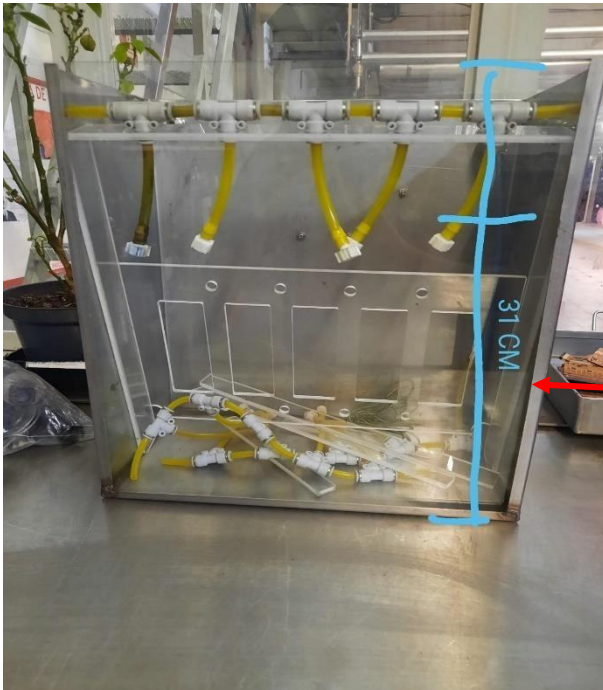
Ilustración 48. Medidas del vidrio para el depósito.
