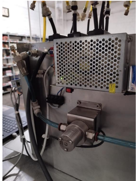
Ilustración 58. Conexión de la fuente de alimentación de 24 v para alimentar la tarjeta de comunicación.
