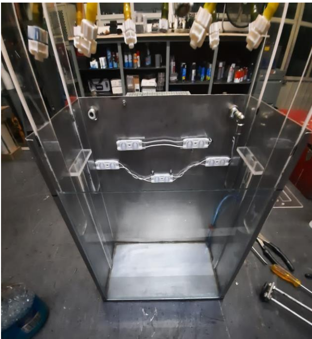
Ilustración 49. Vidrio pegado en el depósito primario.
