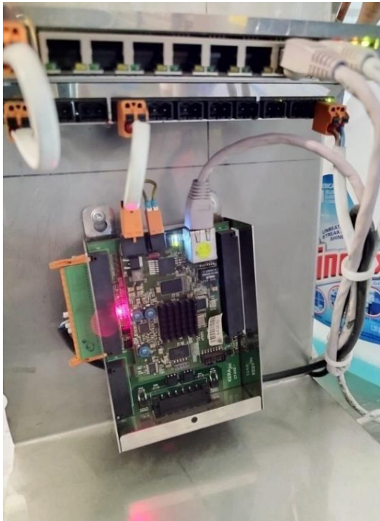
Ilustración 55. Conexión de la bomba con los puertos de la tarjeta de comunicación.
