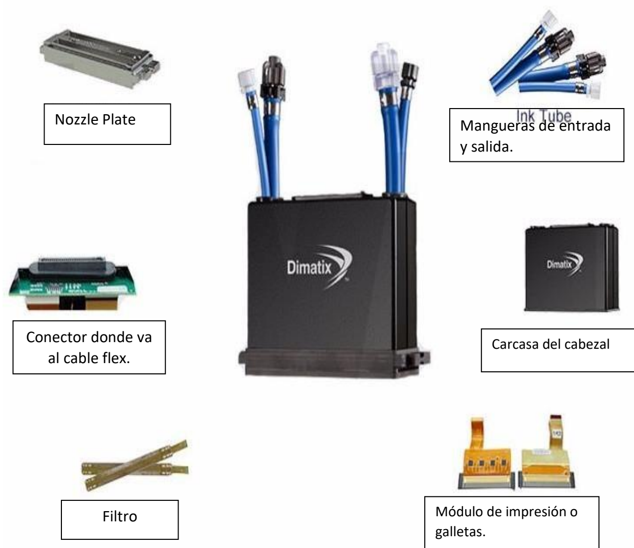
Ilustración 8. Partes del cabezal Star Fire 1024.
