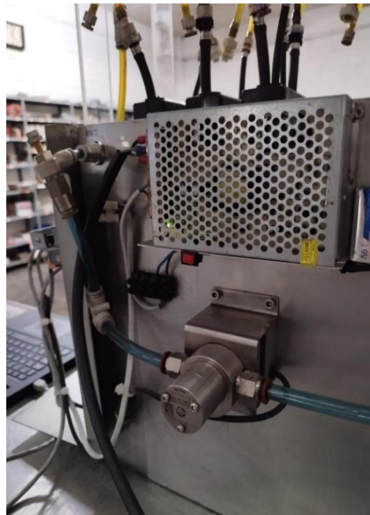
Ilustración 55. Conexión de la bomba con los puertos de la tarjeta de comunicación.
