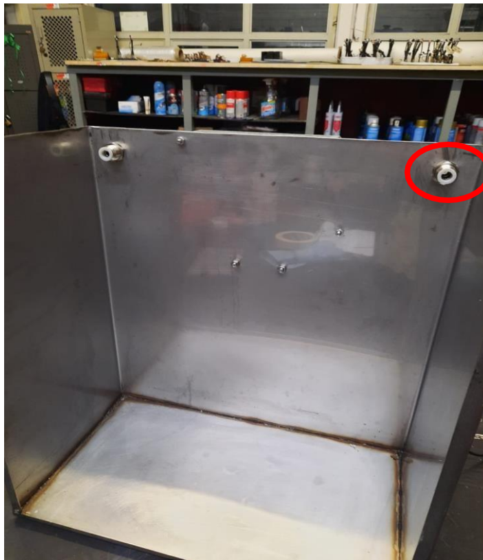
Ilustración 38. Perforaciones en la base para conexiones rápidas.
