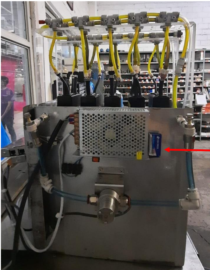
Ilustración 53. Conexión para las tiras led con pila de 9v.
