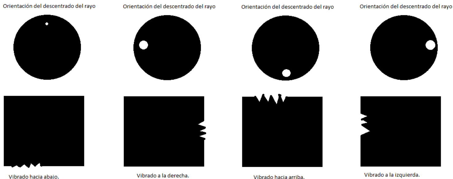
Figura 153. Orientación del vibrado (elaboración propia)
