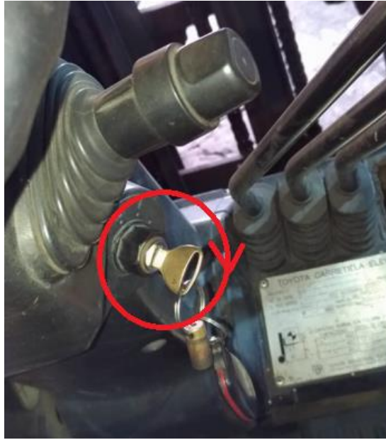
Figura 194. Encendido del montacargas (propiedad de COMETAL).
