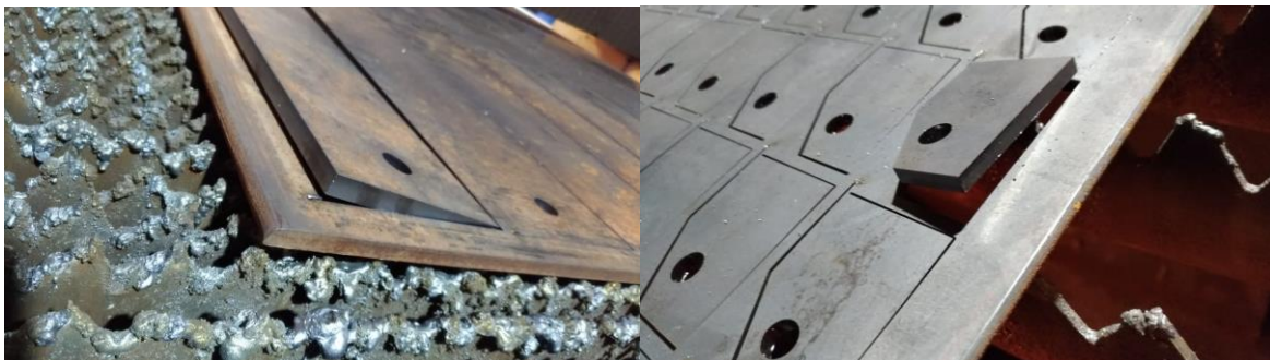
Figura 150. Pieza con potencial a chocar con el cabezal o dañarlo, y mover toda la placa (propiedad de COMETAL).
