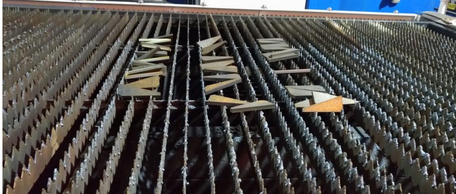
Figura 156. Piezas para retirar de la cama del láser (propiedad de COMETAL).
