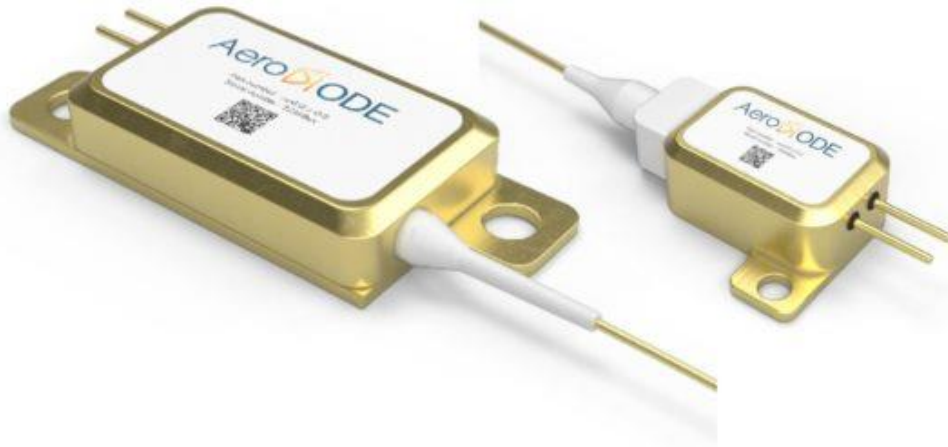
Ilustración 10. Ejemplo de bombas de diodo láser acopladas a fibra multimodo utilizadas en láseres de fibra (izquierda: 30 W @ 976 nm con estabilización de rejilla de volumen Bragg para adaptarse al espectro de absorción estrecho Yb3+; derecha: 10 W @ 915 nm) (AeroDiODE, s.f.)
