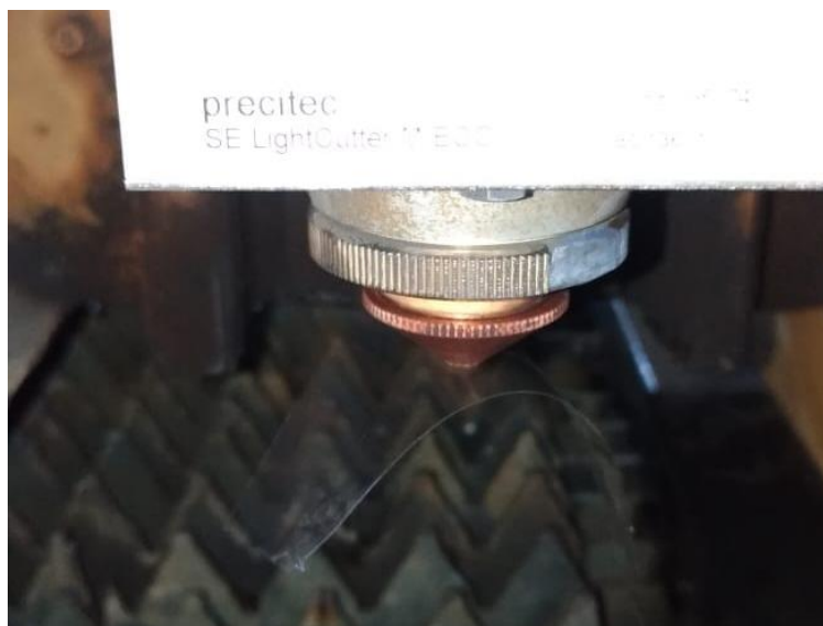
Figura 137. Cinta en la boquilla para el centrado del rayo (propiedad de COMETAL).
