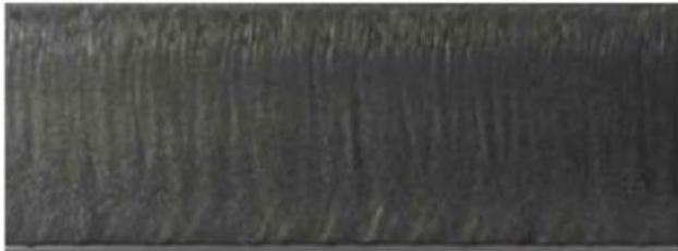
Figura 164. Acabado limpio de placa 1/2" (MATE. PRECISION TECHNOLOGIES.)
