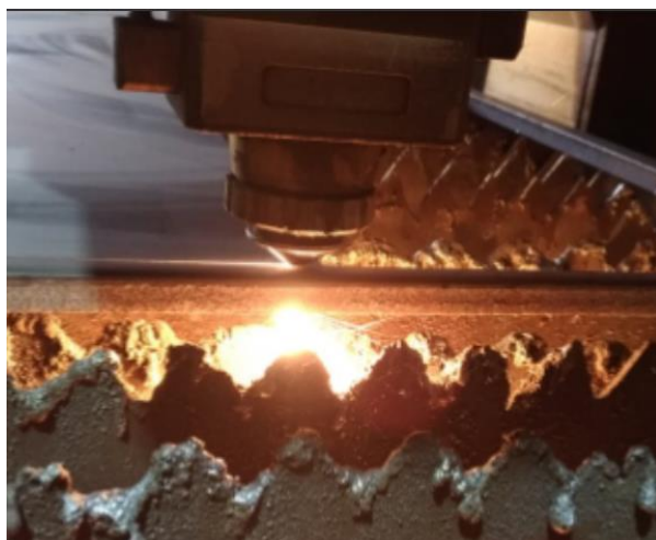
Figura 151. Chispas en forma de abanico (propiedad de COMETAL).
