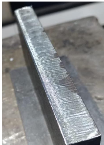
Figura 163. Capa de óxido que se forma después del corte láser, esta capa genera un brillo grisáceo en la orilla de la pieza (propiedad de COMETAL).
