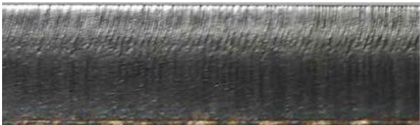
Figura 165. Acabado limpio de placa 1/4" (MATE. PRECISION TECHNOLOGIES.)
