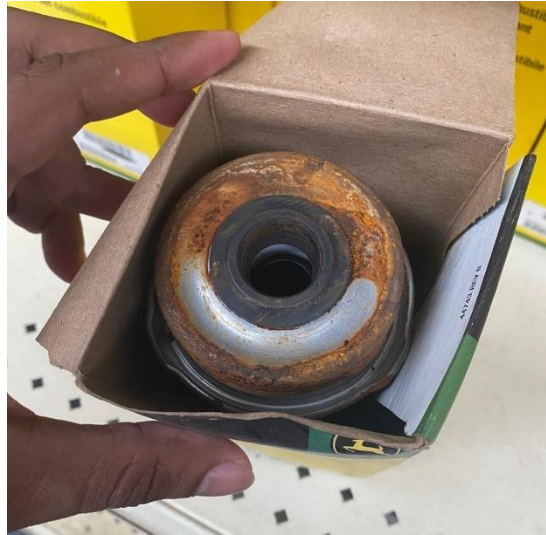
Imagen 2 Producto dañado por óxido
