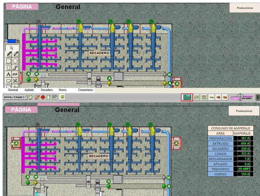
Figura 130 Evidencia de antes y despues de la asignación de las lecturas de consumo de amperaje.
