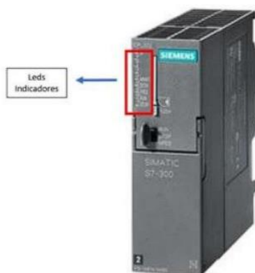
Figura 48 Referencia de la ubicación de los leds de estado.
