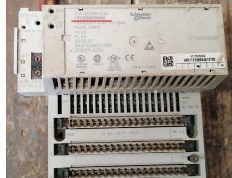
Figura 86 Imagen referencial de un plc momentum.
