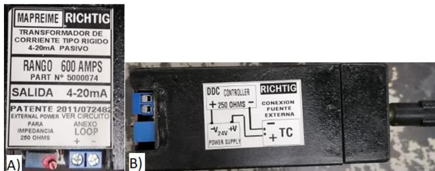
Figura 108 A) Especificaciones del transformador tipo dona. B) Diagrama de conexión del transformador.
