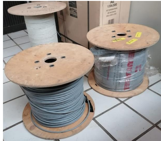
Figura 84 Carretes de cable de control.
