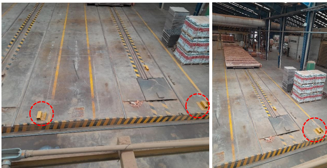
Figura 6. Visualización de sensores instalados.
