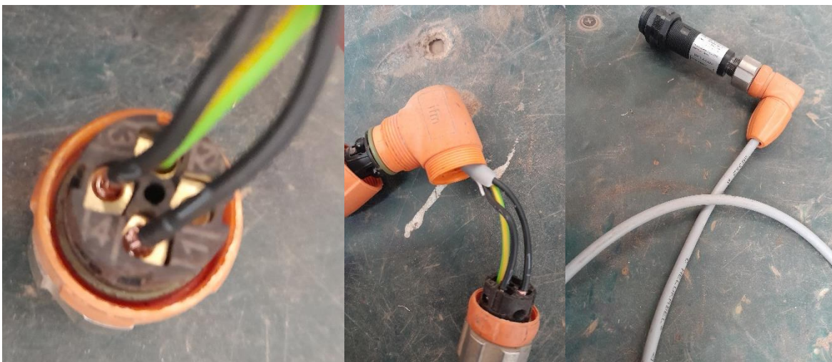
Figura 5.11. Conexión de sensores.
