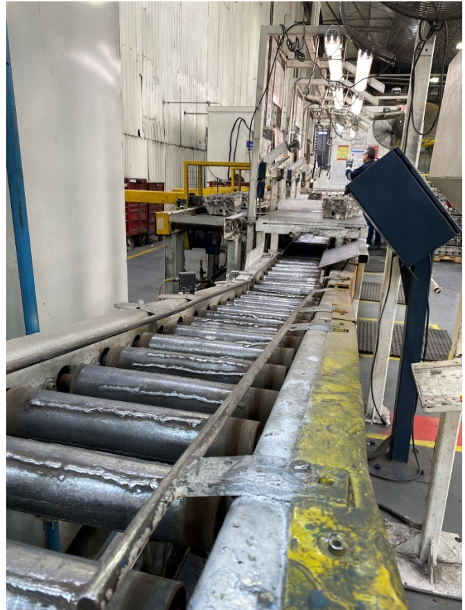
Figura 4.3: Estado actual de la banda transportadora por rodillos. Cortesía (NEMAK)
