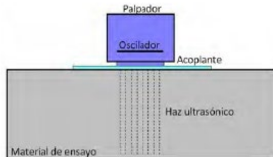
Figura 3.13: Técnica de incidencia normal por contacto directo
