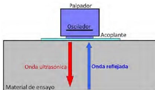
Figura 2.13: Método de contacto con incidencia normal (Cristian Rodríguez, 2012).
