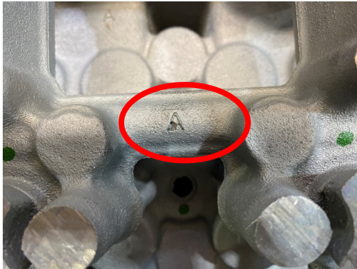
Figura 3.6 Grieta en vena de lubricación (Cortesía, NEMAK).
