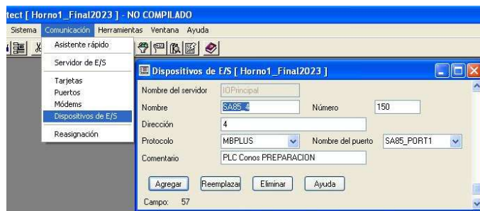
Figura 3.21 (Configuración de comunicación de dispositivos E/S)
