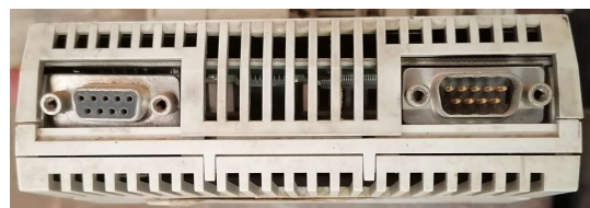
Figura 3.10 (Entradas de la tarjeta AAI con el adaptador montado)
